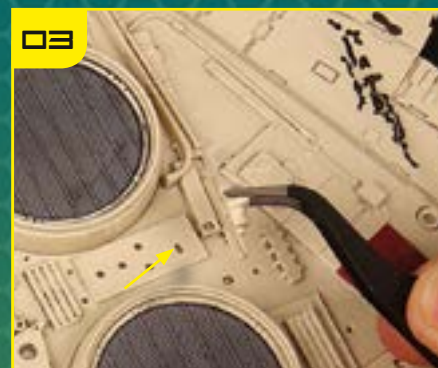
03 Вклейте выступ на обратной стороне детали 1 в указанное гнездо.
